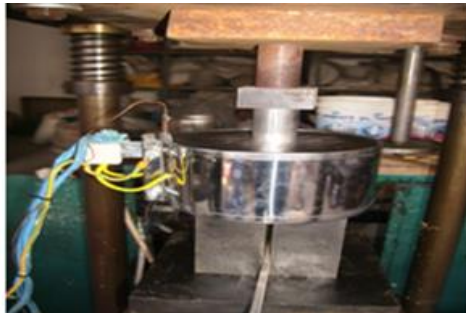
Şekil 3. Prese bağlı kam kalıbı ve ısıtıcı
