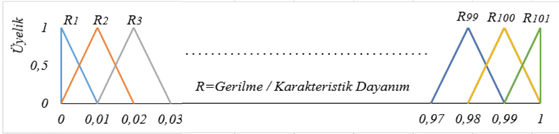
Şekil 4. Gerilme/Karakteristik Dayanım için oluşturulan bulanık kümeler
