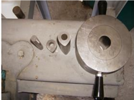
Şekil 1. Üretilen kam kalıbı ve parçaları
