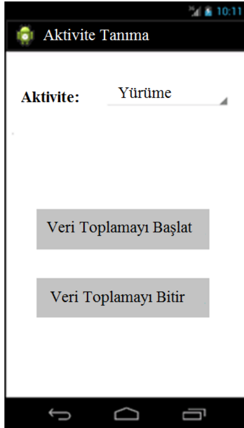
Şekil 1. Cep telefonundaki ivmeölçeren elde edilen ham hızlanma değerlerini elde etmek için kullanılan Android uygulamanın ekran görüntüsü
